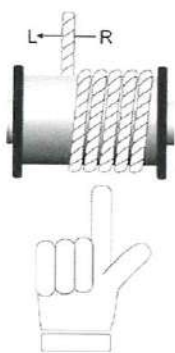
Høyreslått ståltau fra høyre mot venstre
